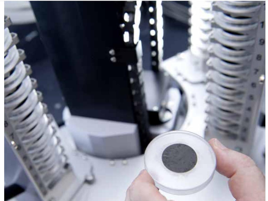
▲ Les sédiments emballant les organismes fossiles trouvés au Gabon (ci-dessus) sont analysés chimiquement grâce à un diffractomètre de rayons X (à gauche). Cela permet la caractérisation des minéraux constituant une roche, un sédiment ou un fossile.
